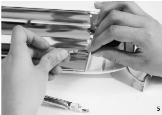
5. DE ESTAR GASTADAS, COLOCAR LAS CÁPSULAS EN EL LUGAR DE AQUELLAS QUITADAS, PELAR LOS CABLES POR 5-6 mm, INTRODUCIR LOS NUEVOS FASTON Y VOLVER A FIJARLOS EN EL CABLE. NO TOCAR LA BOMBILLA CON LAS MANOS DESNUDAS.
