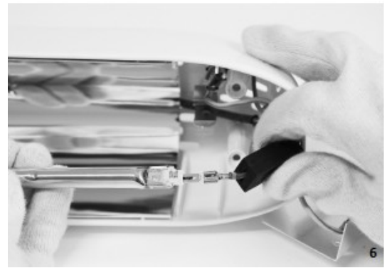
6. CONECTAR LOS FASTON MACHOS DE LA NUEVA BOMBILLA A LOS DE LOS DOS CABLES, RECUBRIRLOS CON LAS CÁPSULAS Y VOLVER A COLOCAR LA BOMBILLA EN LA SEDE DE LOS DOS RESORTES. VOLVER A MONTAR EL EQUIPO PROCEDIENDO EN SENTIDO INVERSO.
