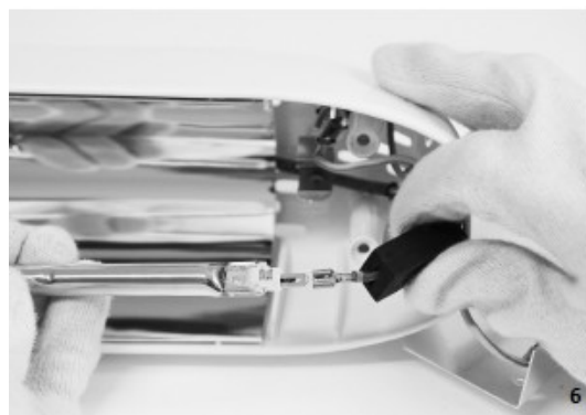
6. COLLEGARE I FASTON MASCHI DEL NUOVO BULBO A QUELLI DEI DUE CAVI, RIVESTIRLI CON LE CAPSULE E RIPOSIZIONARE IL BULBO NELLA SEDE DELLE DUE MOLLETTE. RICOMPORRE L'APPARECCHIO PROCEDENDO ALL'INVERSO.
