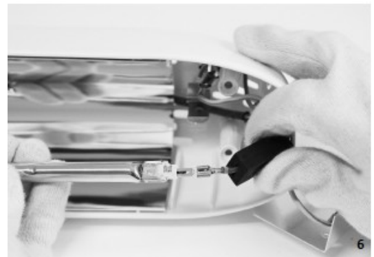
6. DIE FLACHSTECKER DER NEUEN LAMPE MIT JENEN DER BEIDEN KABEL VERBINDEN, DIE DICHTUNGEN ÜBERZIEHEN UND DIE LAMPE IN DEN SITZ DER BEIDEN FEDERN EINSETZEN. DEN HEIZSTRAHLER IN UMGEKEHRTER REIHENFOLGE WIEDER ZUSAMMENBAUEN.
