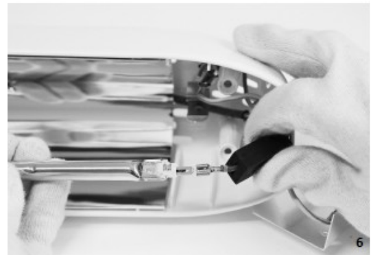
6. CONNECTER LES CONNECTEURS MALES DE LA NOUVELLE AMPOULE A CEUX DES DEUX CABLES LES RECOUVRIR AVEC LES CAPSULES ET REPOSITIONNER L'AMPOULE DANS LE SIEGE DES DEUX RESSORTS. RECOMPOSER L'APPAREIL EN SUIVANT LA PROCEDURE A L'ENVERS.
