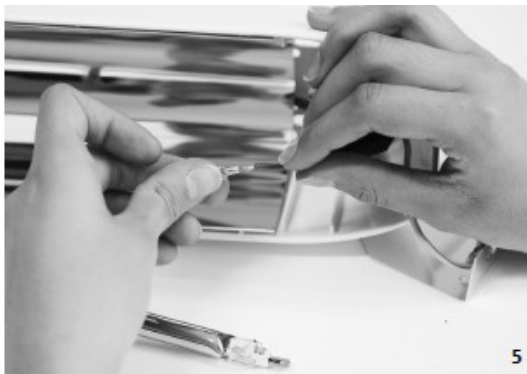
5. BEI VERSCHLEISS NEUE DICHTUNGEN ANBRINGEN, DIE KABEL 5-6 mm ABISOLIEREN, DIE NEUEN FLACHSTECKER ANBRINGEN UND AM KABEL BEFESTIGEN. DIE LAMPE NICHT MIT BLOSSEN HÄNDEN ANFASSEN.
