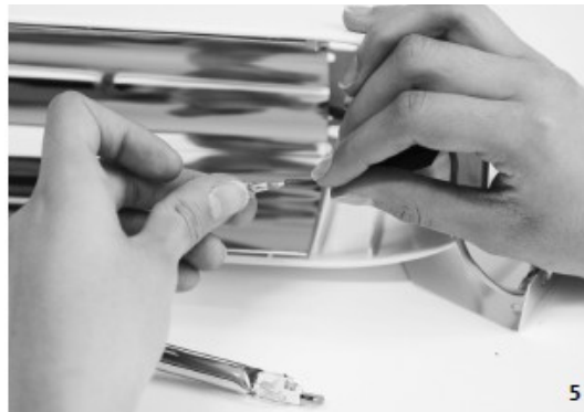
5. SI USAGEES, INTRODUIRE LES CAPSULES A LA PLACE DE CELLES QUI ONT ETE ENLEVEES, PELER LES CABLES POUR 5-6 mm, INTRODUIRE LES NOUVEAUX CONNECTEURS ET LES FIXER SUR LE CABLE. NE PAS TOUCHER L'AMPOULE LES MAINS NUES.
