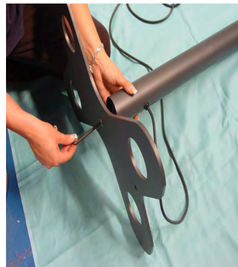
3. Unire le due parti che compongono il basamento quadrilobato (D) e avvitarlo al palo più corto (A), dentro cui scorre il cavo di alimentazione, utilizzando le viti 8x25 a testa svasata a brugola serrandole con la brugola 5 in dotazione.
