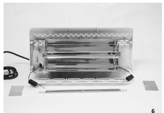
6. COLOCAR LAS CÁPSULAS EN EL LUGAR DE AQUELLAS QUITADAS
