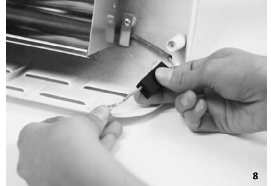
8. ENFILER LES NOUVELLES COSSES (FASTON) DE RECHANGE ET LES SERTIR SUR LES FILS.
