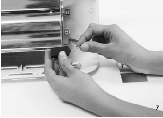
7. PELAR LOS CABLES POR 5-6 mm
