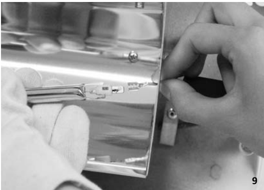
9. RACCORDER LES COSSES (FASTON) MÂLES DU NOUVEAU TUBE À CELLES DES DEUX FILS D'ALIMENTATION, LES RECOUVRIR AVEC LES PROTECTIONS ET REMETTRE LE TUBE DANS SON LOGEMENT DANS LES CLIPS. NE PAS TOUCHER L'AMPOULE À MAINS NUES.
