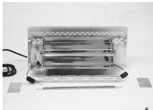
6. IBEI VERSCHLEISS NEUE DICHUNGEN ANBRINGEN, DIE KABEL 5-6 mm ABISOLIEREN, DIE NEUEN FLACHSTECKER ANBRINGEN UND AM KABEL BEFESTIGEN
