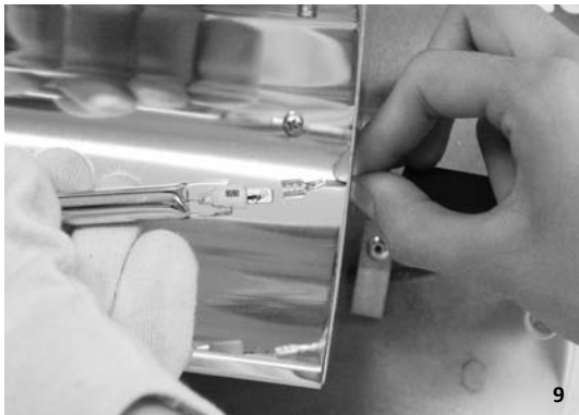
9. COLLEGARE I FASTON MASCHI DEL NUOVO BULBO A QUELLI DEI DUE CAVI, RIVESTIRLI CON LE CAPSULE E RIPOSIZIONARE IL BULBO NELLA SEDE DELLE MOLLETTE.
