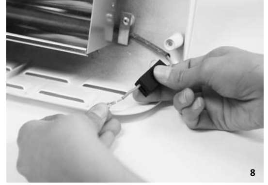
8. INFILARE I NUOVI FASTON DI SCORTA E SCHIACCIARLI SULLA PARTE SPELATA DEI CAVI. FARE ATTENZIONE A NON TOCCARE IL BULBO A MANI NUDE.
