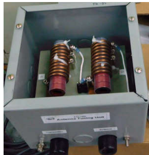
Sender und Antenne werden mit diesem Gerät aufeinander abgestimmt
